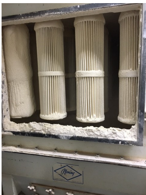
Filter links in beeld verzadigd met bloem vóór het pulsen
